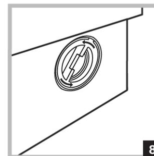
2. выверните крышку фильтра, вращая ее против часовой стрелки (см. рис. 8): из насоса может вылиться немного воды – это нормальное явление.
