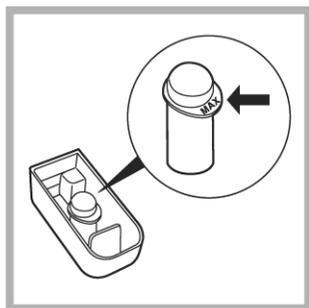
Лоток 4 для отбеливателя вставляется в отделение 1 распределителя моющих средств. Не заполняйте лоток 4 выше отметки max (см. рис.). Для осуществления **только отбеливания** налейте отбеливатель в дополнительную вставку 4 и выберите программу Полоскание
