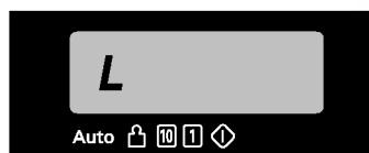
Чтобы отменить режим БЛОКИРОВКИ ОТ ДЕТЕЙ, нажмите и удерживайте кнопку Стоп/Сброс, пока дисплей не перестанет показывать букву "L". После снятия блокировки вы услышите звуковой сигнал.
