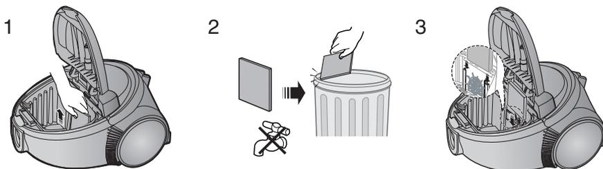
**ПРИМЕЧАНИЕ :** Регулярно проверяйте, не засорился ли фильтр; если это произошло, удалите частицы пыли из фильтра, поскольку засоренный фильтр может привести к повреждению двигателя или снижению всасывающей силы.
