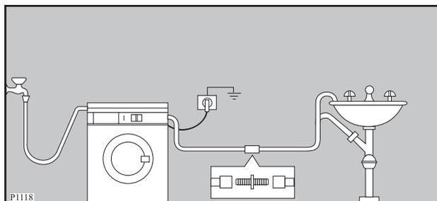
**Для обеспечения правильной работы машины сливной шланг должен быть всегда подвешен за соответствующий кронштейн, расположенный в верхней части задней панели машины.**
