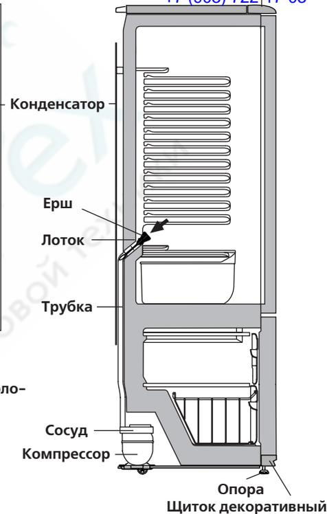
Рисунок 6 — Схема отвода талой воды из холодильной камеры
