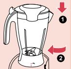
**2 Встановіть глек міксеру на вузол двигуна з пазом проти напівкруглої позначки на корпусі двигуна (1). Потім поверніть глек міксеру вліво, поки він не зафіксується з клацанням (2).**
