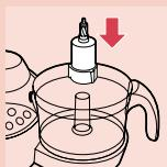
**1** Stavite posudu na jedinicu motora i okrećite je na levo sve dok ne čujete klik.
