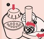
электродвигателя. Когда насадки установлены правильно, встроенная блокировка будет разблокирована.
