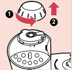
**1 Для встановлення глеку міксеру зніміть гвинтовий ковпачок з вузла двигуна.**
