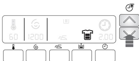
Эта функция позволяет изменять время стирки, автоматически предлагаемое стиральной машиной.
