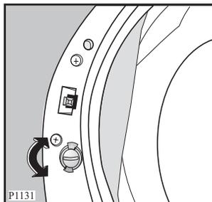
Для отключения этого устройства, чтобы снова можно было закрыть дверцу, поверните кнопку против часовой стрелки так, чтобы паз оказался в вертикальном положении.
