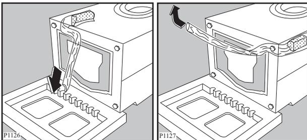
6. Поставьте машину в вертикальное положение и выньте оставшийся на задней панели болт. Выньте соответствующую пластмассовую шпильку.
