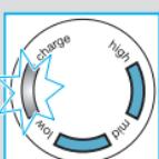
Gdy poziom naładowania akumulatora spadnie poniżej 20 proc., wyświetlony zostanie migający czerwony segment, pod warunkiem, że golarka będzie włączona. Pozostała energia wystarczy jeszcze na 2–3 golenia.
