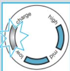
Červený segment pro nízké nabití se rozsvítí pokud poklesne kapacita baterie pod 20% (je-li holící strojek zapnutý). Zbývající kapacita pak postačí na 2 až 3 oholení.
