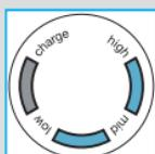
Na wyświetlaczu golarki ⑯ wyświetlany jest poziom naładowania akumulatora. Podczas ładowania lub golenia wyświetlany jest migający zielony segment. Gdy golarka jest całkowicie naładowana, oba segmenty poziomu naładowania akumulatora będą się świecić przez cały czas, pod warunkiem, że golarka będzie włączona lub podłączona do gniazdka elektrycznego.
