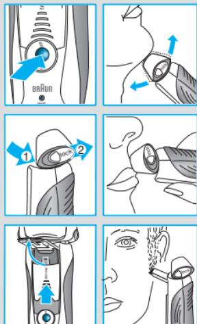
Pritisnite prekidač za uključivanje/isključivanje ⑫:
