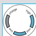
Kada je aparat uključen segment s crvenim okvirom bljeskanjem označava da baterija ima manje od 20% snage. Preostali kapacitet dovoljan je za 2 do 3 brijanja.
