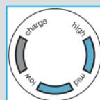
Makine çalışır durumda iken, pil şarj kapasitesi %20'nin altına indiğinde kırmızı renkli düşük şarj göstergе bölmesi yanmaya başlar. Bu durum, pilde 2-3 tıraş için yetecek kadar güç kaldığı anlamına gelir.
