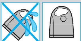
تأكد من وضع جهاز «كلين آند رينيو» على سطح مستوٍ مستقر لضمان عدم تسرب السائل المنظف. وعند تغيير عبوة السائل المنظف، لا تقلب الجهاز أو تحركه فجأة أو تنقله بأي شكل حتى لا يتسرّب السائل المنظف. لا تضع جهاز «كلين آند رينيو» داخل خزانة المرأة أو فوق سطح مصقول أو ملمع.
