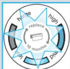
Değiştirme sembolü sonraki 7 tıraş boyunca size elek-bıçak değişim zamanının geldiğin, hatırlatmak üzere ekranda kalacaktır. Daha sonra makine otomatik olarak ekran görüntüsünü sıfırlar.
