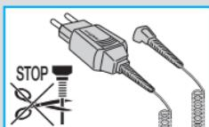
Vaš brivnik je opremljen s posebnim kablom z integriranim, izjemno varnim, nizkonapetostnim napajalnikom in z omrežnim vtičem. Kabla oziroma njegovih delov ne smete spremenjati oziroma posegati vanje, sicer obstaja nevarnost električnega šoka.
