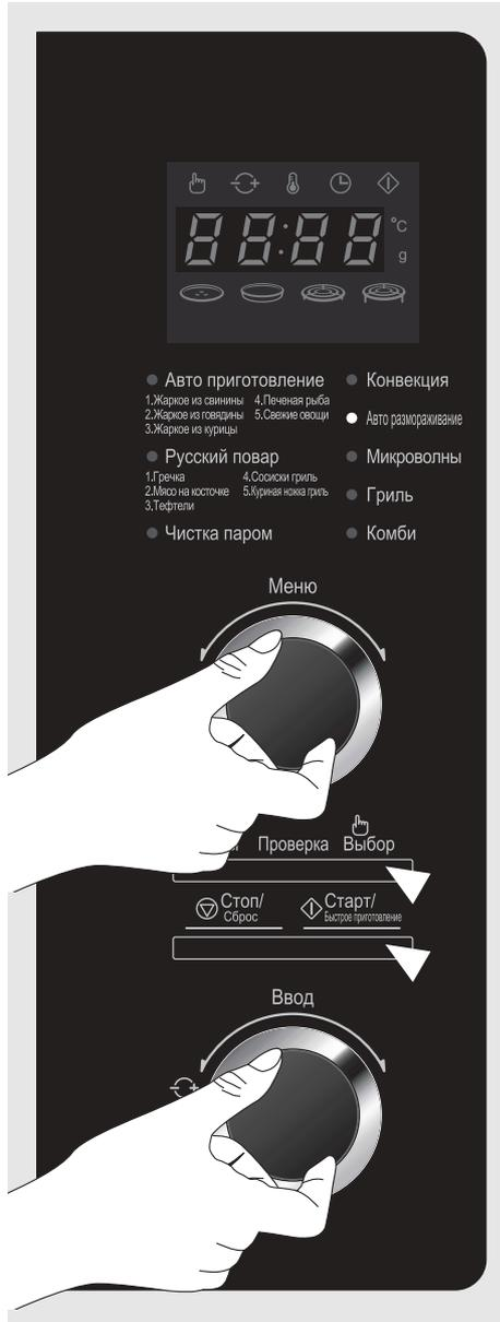
1. Поворотом ручки-регулятора Меню установите режим Авто размораживание.
