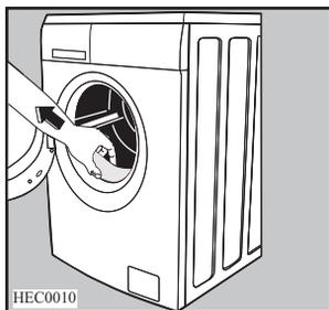
7. Do malého horního otvoru a dvou širokých otvorů vložte odpovídající plastové krytky, které jsou uloženy v sáčku s návodem k použití.
