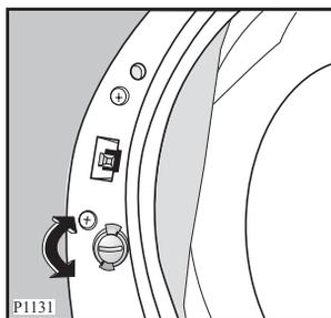
Zařízení se vypne pootočením tlačítka doleva, až je zářez svisle; nyní se dvířka dají opět zavřít.
