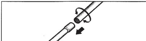
**ПОЛНИТЕЛЬНО:** Регулировка телескопической трубки (зависит от модели).
